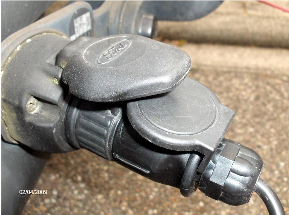
Abb. 13: Elektrische Steckverbindung mit Adapter von 7-polig (Trailer) auf 13-polig (Zugfahrzeug)
