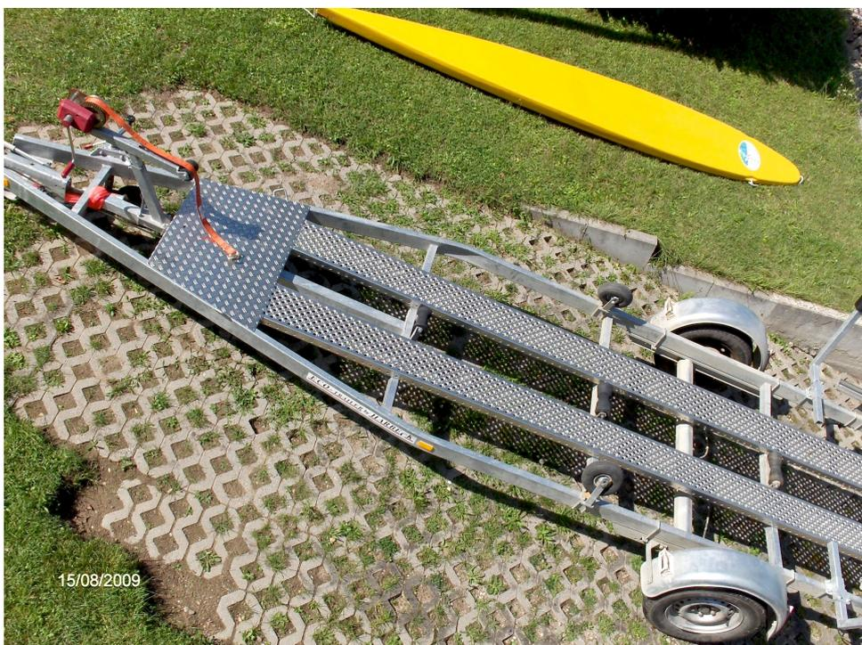
Abb. 9: Trailer mit Laufblechen für den Helfer an der Trailerwinde
