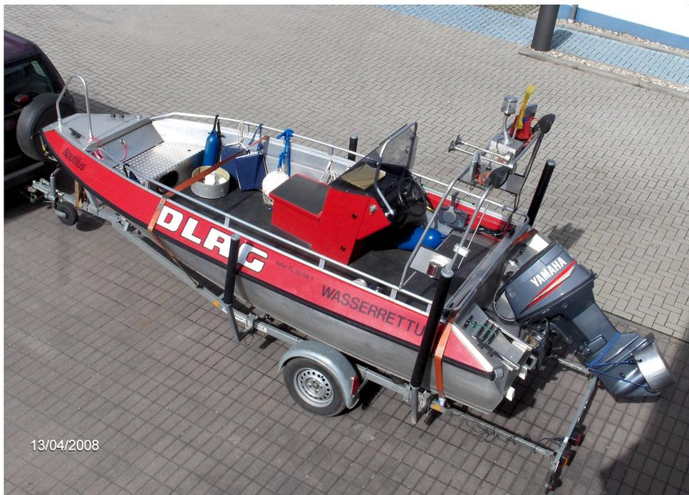
Abb. 4: Trailer mit MRB vom Typ Buster L, tatsächliche Gesamtmasse von Boot und Trailer knapp unter 750 kg; zulässige Gesamtmasse des Trailers 750 kg, daher keine Probleme mit Führerschein B
