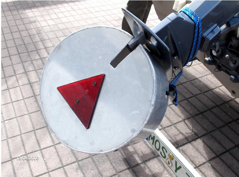
Abb. 16: Propellerschutz beim Trailern eines Bootes, Motor zum Fotografieren hochgefahren. Ein passender Plastikeimer tut es auch.
