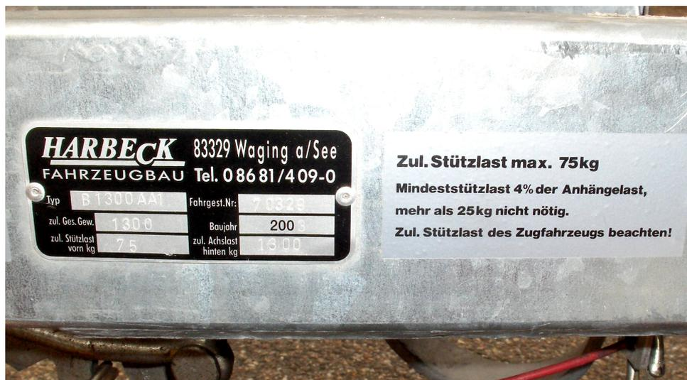
Abb. 2: Typenschild und Hinweise an der Deichsel eines Trailers mit 1300 kg zulässiger Gesamtmasse und einer maximalen Stützlast von 75 kg
