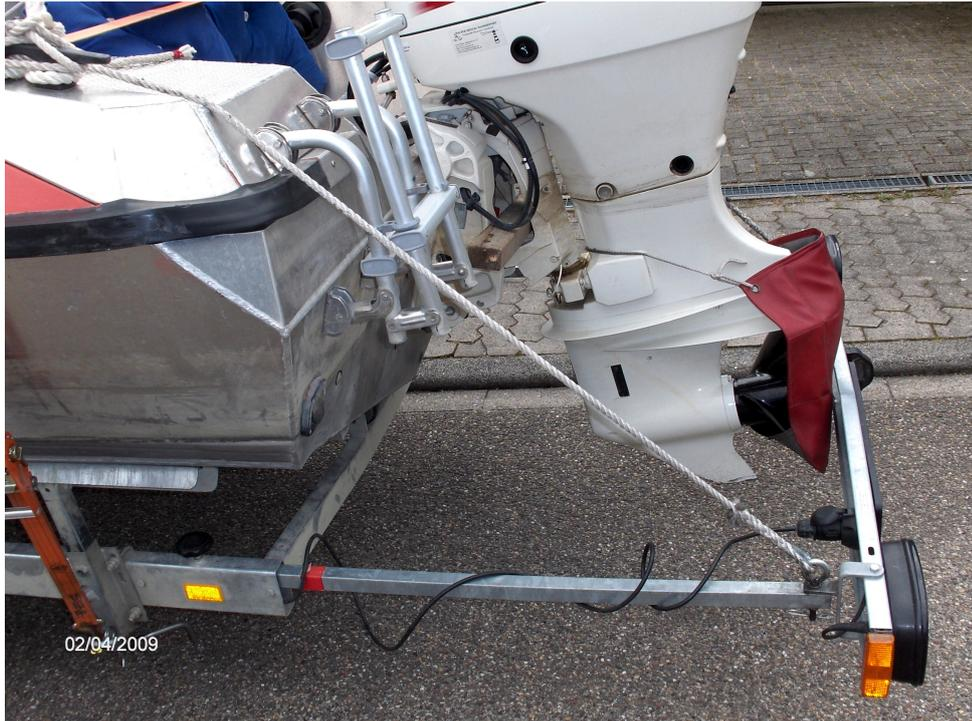
Abb. 10: Abspannung des Leuchtenträgers am Trailer, Propellerschutz durch ein Polster
