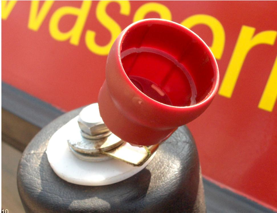
*Abb. 18:* Halterung für den Stecker vom Trailer zum Leuchtenträger während des Slippens, angebracht auf einer Einweiserrolle
