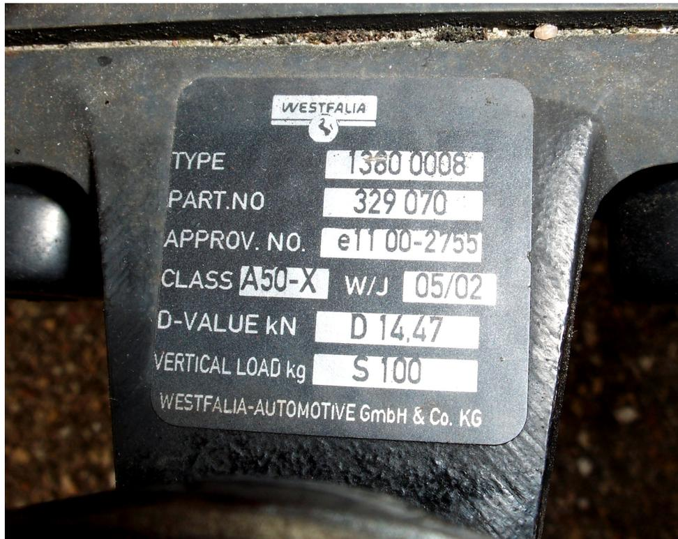
Abb. 3: Typenschild des Kupplungshakens am Zugfahrzeug, hier maximal 100 kg Stützlast (Vertical Load)
