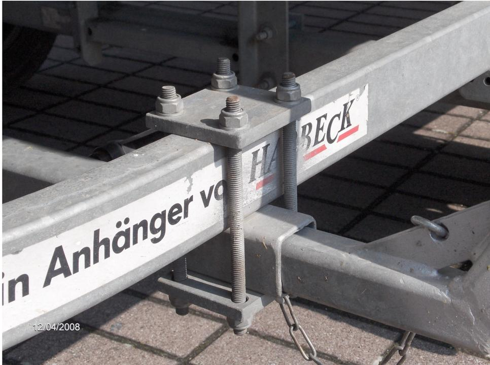
Abb. 11: Trailer mit angeklemmtem Teil, nicht geschraubt oder geschweißt
