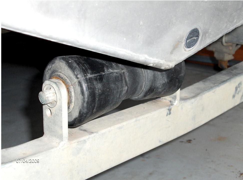
*Abb. 12:* Bootsheck liegt auf achterster Kielrolle, hohe Last durch den Außenbordmotor, Kiel durch Spiegel verstärkt
