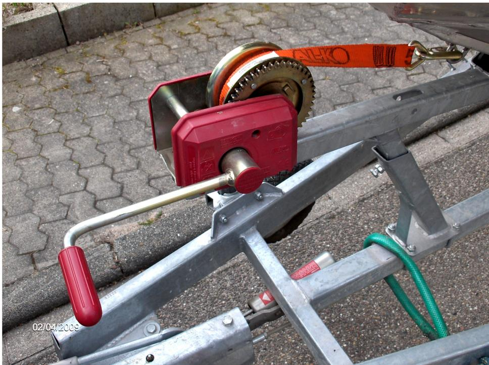
Abb. 8: Trailerwinde mit Gurt anstelle Drahtseil, sehr zu empfehlen
