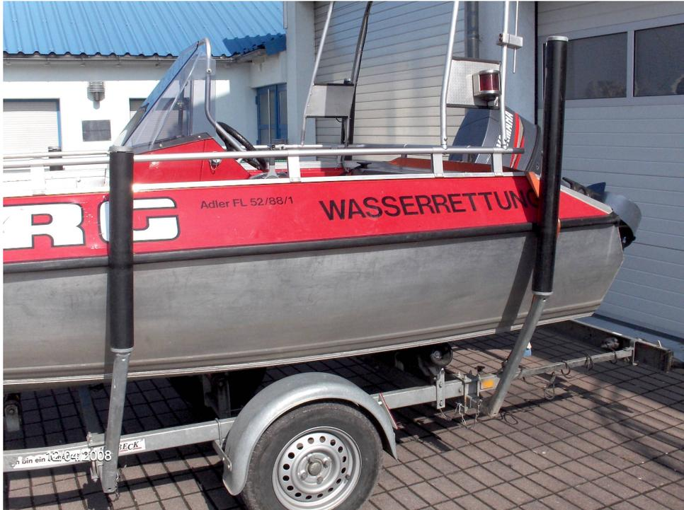
Abb. 6: Trailer mit Aufslipphilfe (Einweisern) in Form von vertikalen Führungsrollen
